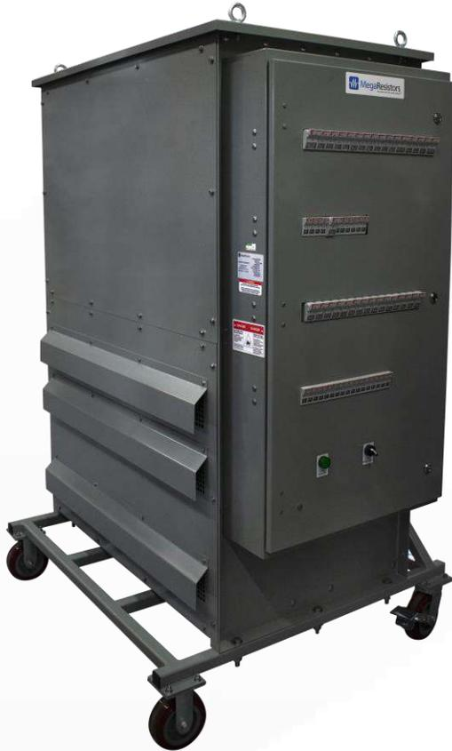
Se colocan en paralelo con equipos de alto voltaje para liberar la carga de condensadores o baterías antes de mantenimiento. Pueden usarse para descargas rápidas o conectarse permanentemente para mayor confiabilidad y menor costo, equilibrando el tiempo de descarga y la pérdida de energía en reposo.
